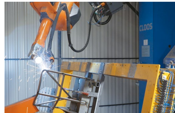
Bild oben: Früher hat ein MAP-Mitarbeiter 150 dieser Kleinteile in einer Schicht handgeschweißt, heute schafft der Schweißroboter in der Kompaktanlage 350 Teile pro Schicht.
