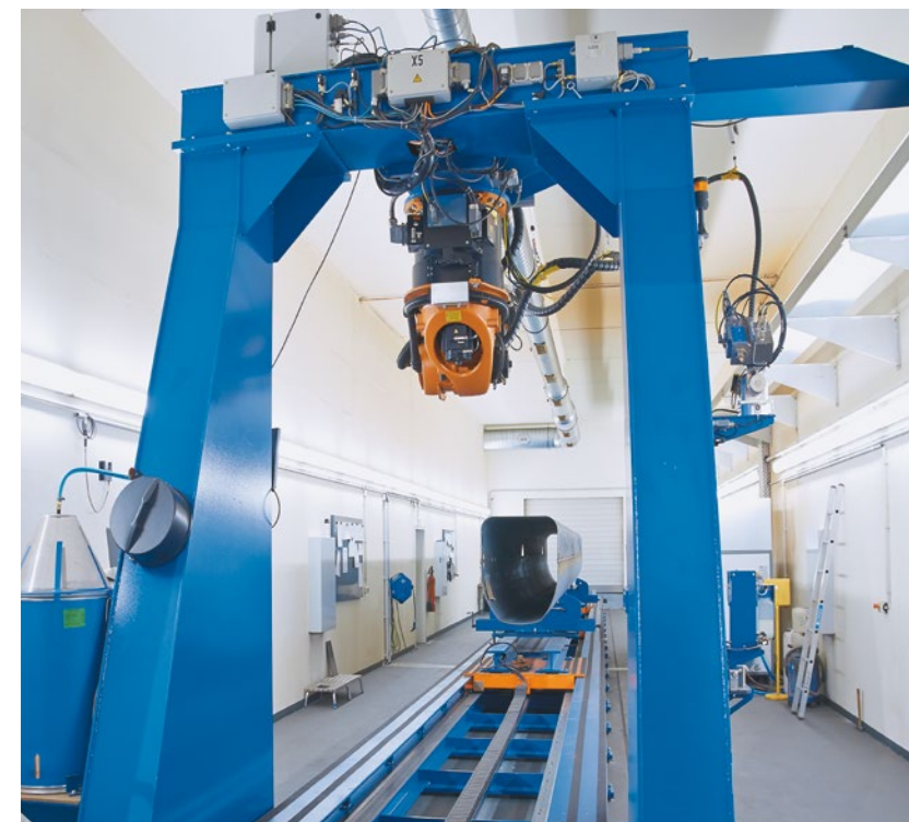
Bild oben: Die Teleskop-Mobilkran-Ausleger werden mit Laser-MSG-Hybrid-Technologie geschweißt. Manitowoc löste damit das UP-Schweißen ab und sparte so 200.000 € allein an Zusatzwerkstoff und Pulver ein.
