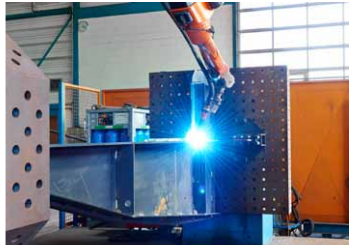
Bild 4: Der 7-achsige Roboter kann dank seiner großen Reichweite einfach um Ecken oder in Nischen geführt werden.
