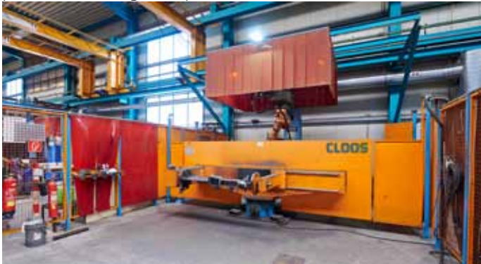
Bild 2: Durch den Zwei-Stationen-Aufbau kann die Anlage wechselseitig beschickt werden – ein enormer Zeitgewinn im Prozessablauf.
