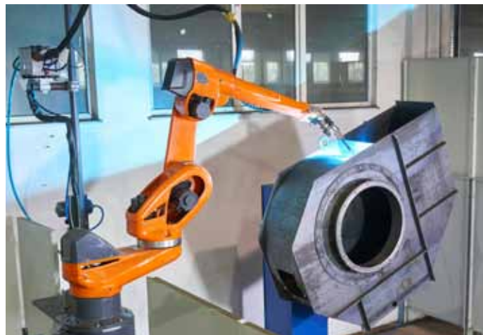
Bild 1: Über 100 verschiedene Ventilatorarten werden mit der neuen Roboteranlage geschweißt.
