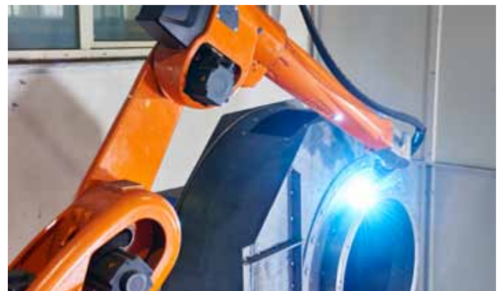
Bild 2: Die hohe Reichweite des 7-achsigen Roboters vereinfacht und beschleunigt das Schweißen
