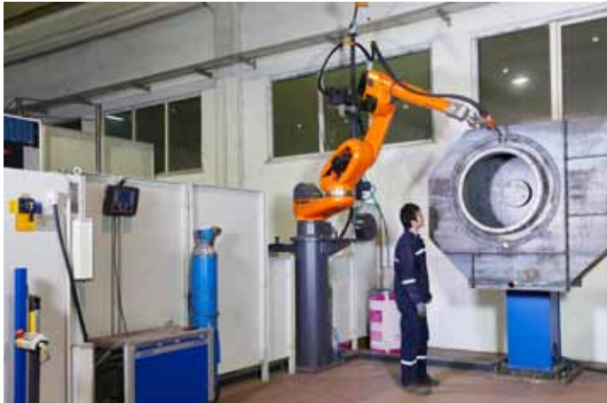
Bild 3: Da die Anlage automatisch arbeitet, kann sich der Schweißer intensiver auf die Prozessüberwachung konzentrieren.
