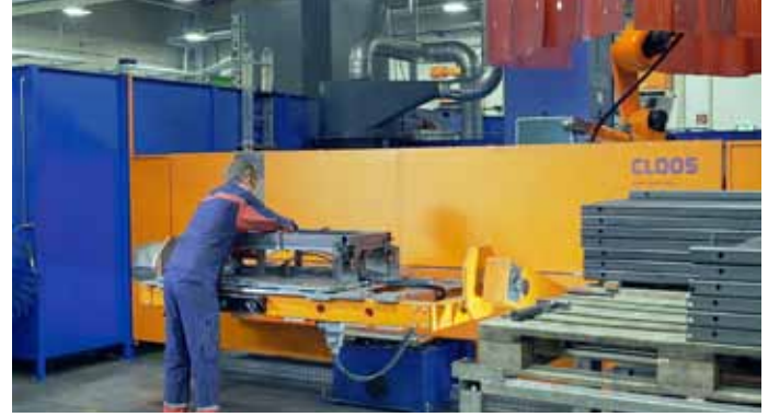
Bild 6: Durch den Mehrstationen-Aufbau der Anlagen kann die Be- und Entladung zeitgleich zum Schweißprozess stattfinden.
