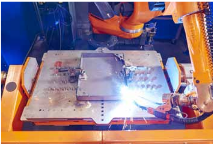
Bild 5: Die große Reichweite des siebenachsigen Roboters vereinfacht und beschleunigt das Schweißen der komplexen Werkstücke.
