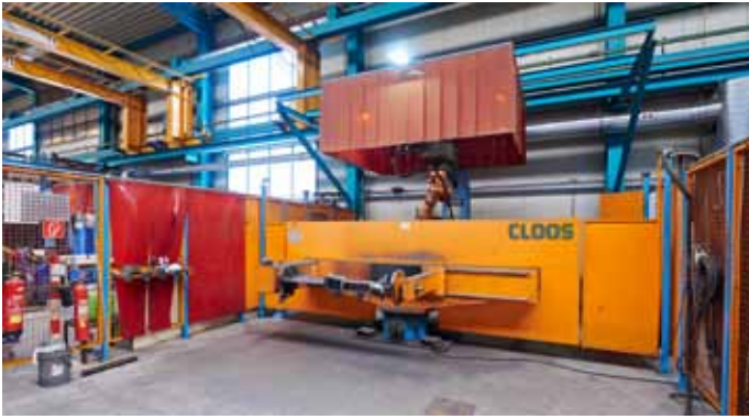
Bild 4: Der Positionierer bringt das Werkstück immer in die für das Schweißen optimale Position.
