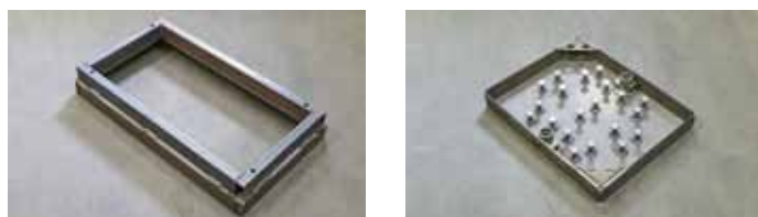
Bild 1+2: Auf den beiden CLOOS-Anlagen werden Schachtsysteme für die Kabelverteilung geschweißt.
