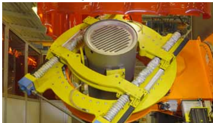
Bild 1: Der Positionierer greift, spannt und dreht die Kessel vollautomatisch.
