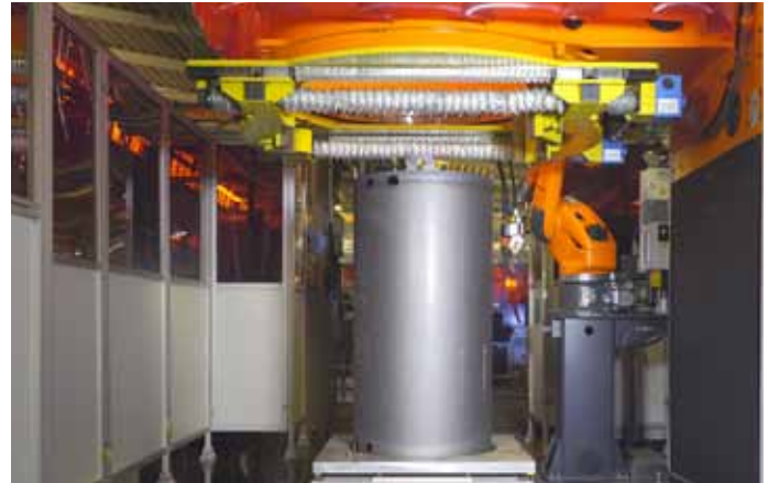
Bild 5: Die neue CLOOS-Roboteranlage eignet sich für unterschiedliche Kesseltypen.
