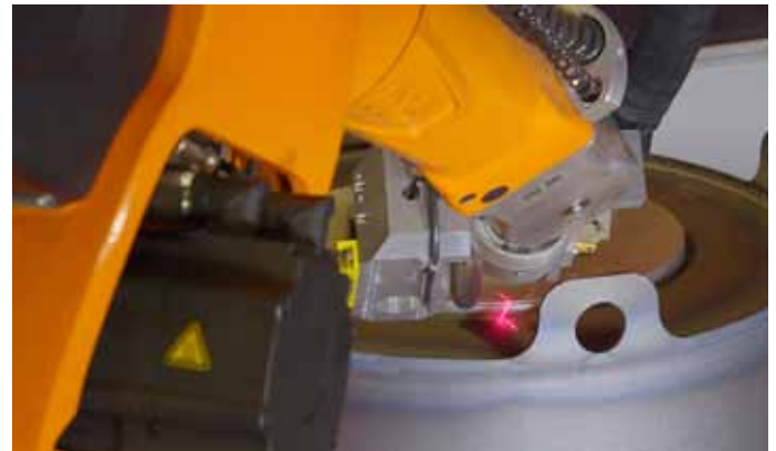
Bild 2: Der Online-Lasersensor gleicht Bauteiltoleranzen direkt während des Schweißprozesses aus.
