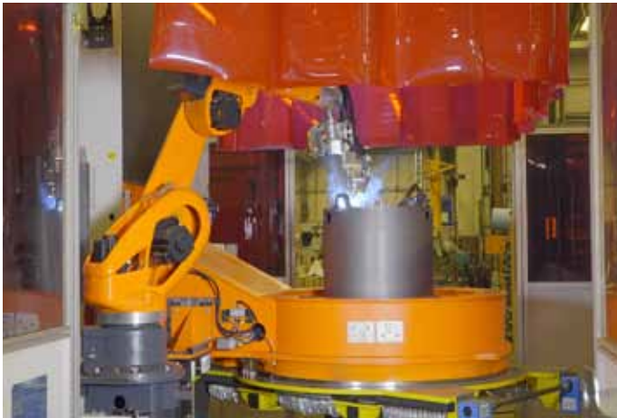
Bild 4: Der QIROX-Roboter schweißt die Kessel von beiden Seiten.
