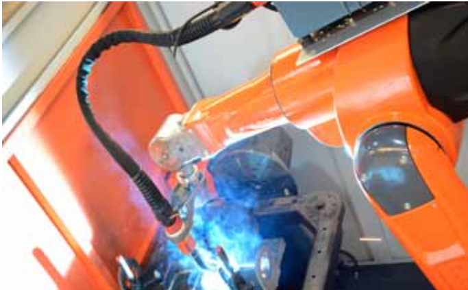
Bild 4: Der neue QIROX-Schweißroboter QRH-280 agiert besonders schnell und hochdynamisch.
