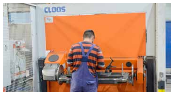
Bild 3: Durch den 2-Stationen-Aufbau kann der Mitarbeiter eine Station bestücken, während der Roboter auf der anderen Station schweißt.
