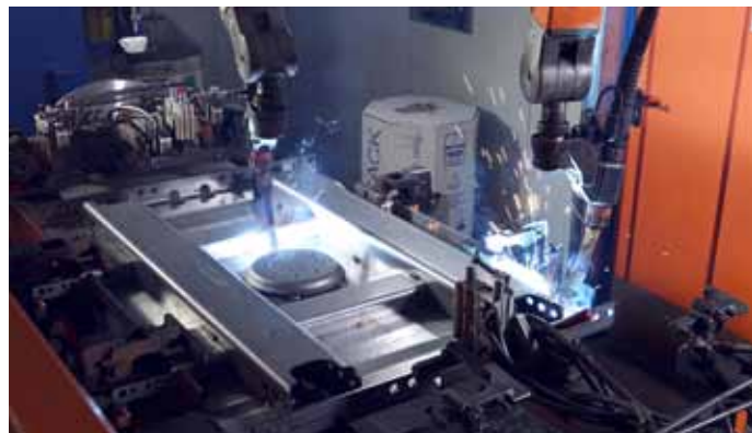
Bild 1: CLOOS-Roboter schweißen Bauteile für LKW-Auflieger.
