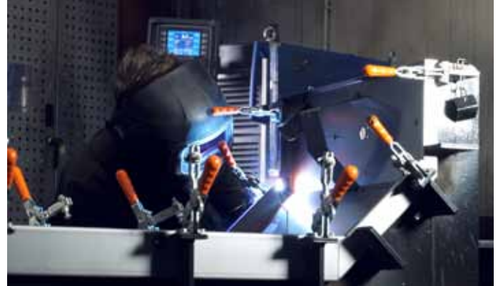
Bild 6: Schweißen einer Motorabdeckhaube für eine Baumaschine mit QINEO Pulse.
