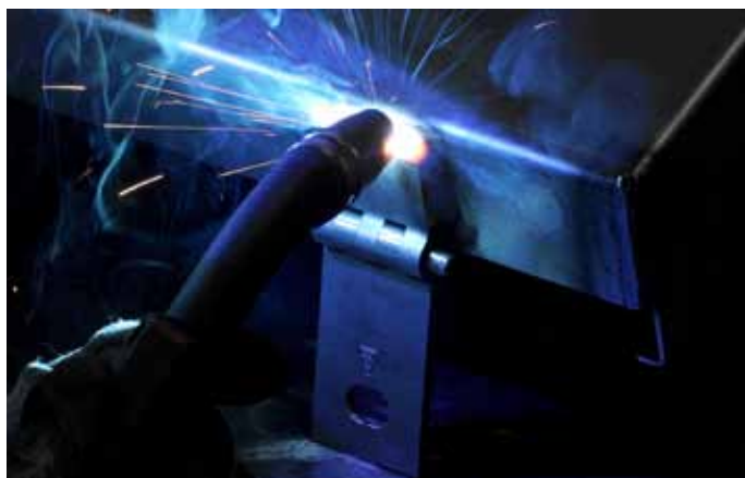
Bild 5: Wenn sich das Roboterschweißen aufgrund von Stückzahl oder Bauteilgeometrie nicht lohnt, werden die Teile per Hand geschweißt.
