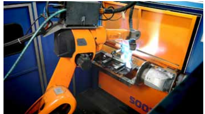
Bild 2: Fertigung von Griffleisten für LKW-Auflieger mit QIROX-Kompaktzelle QR-CC-4.
