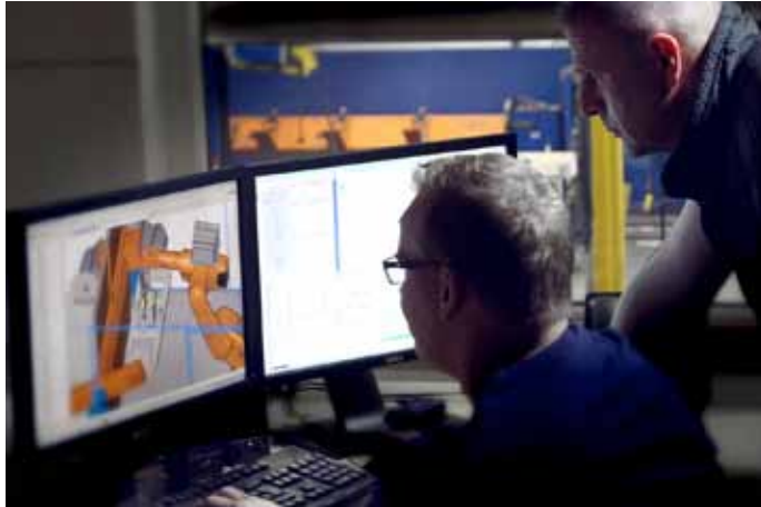
Bild 4: Die Offline-Programmierung der Roboteranlagen erfolgt mit der RoboPlan-Software von CLOOS.
