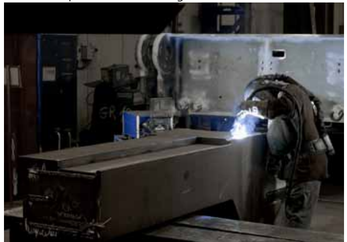
Die neuen Geräte von Cloos kommen beim Schweißen von Schiebeträgern für Raupenkrane zum Einsatz
