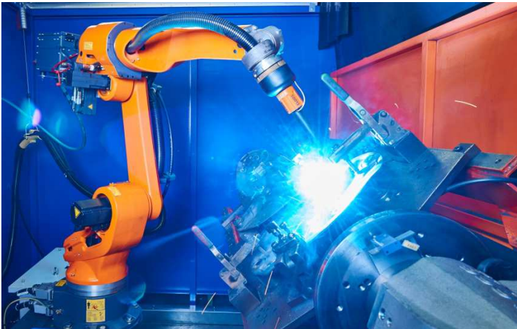
Abb. 1: Qirox QRH-280 in Aktion: Von speziellen Technologiebausteinen über den Box-PC und die Steuerungstechnik bis hin zu den Antrieben; Baumüller hat neben den Motoren auch die komplette Automatisierung für den Cloos-Roboter übernommen
