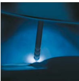
Bild 3: Der neue Schweißprozess MoTion Control Weld eignet sich vor allem für Anwendungen im Dünnsblechbereich.
