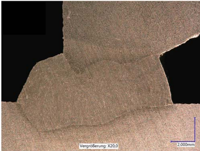
Bild 2: Makroschliff eines einseitig von rechts geschweißten T-Stoßes mit Öffnungswinkel von 30°.
