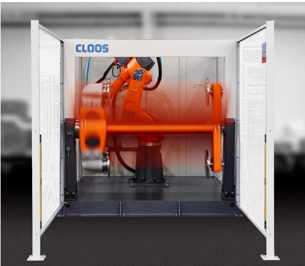
Bild 2: Mit den kompakten Roboterzellen lassen sich kleine Bauteile effizient automatisiert schweißen.
