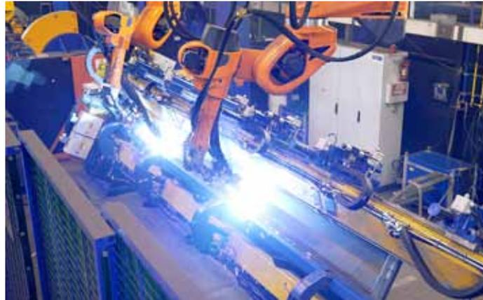
Bild 3: Tandem Weld erzielt höchste Schweißgeschwindigkeiten und steigert gleichzeitig die Fertigungsqualität.
