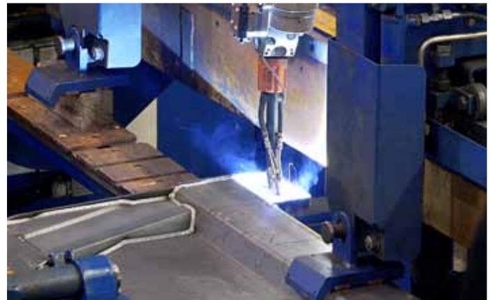
Bild 4: Der Schweißbrenner ist mit einem Lasersensor ausgestattet, der die Bearbeitungsstrecke online während des Schweißens vermisst.
