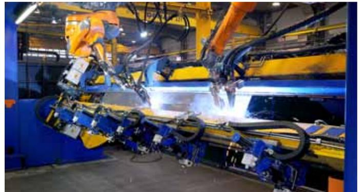
Bild 2: Die neue CLOOS-Roboteranlage schweißt Seitenwände für LKW-Kippaufbauten mit Tandem Weld.
