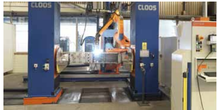
Bild 4: Auch beim Schweißen setzt Driescher-Wegberg auf Automatisierung.
