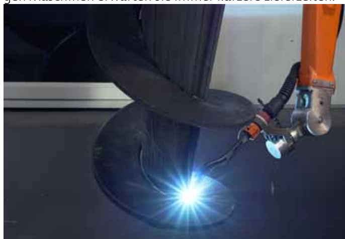
Bild 1: Der Roboter schweißt die anspruchsvollen Radialnähte der Schneckenverdichter gleichmäßig in konstant hoher Qualität.
