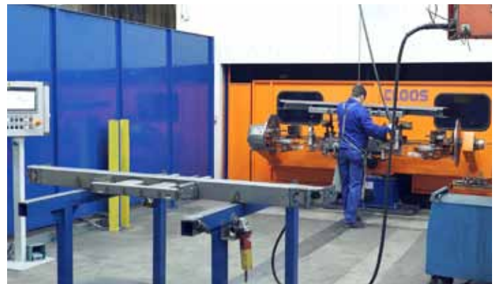
Bild 3: Durch den 2-Stationen-Aufbau kann der Anlagenbediener die eine Station bestücken, während die Roboter auf der anderen Station schweißen.
