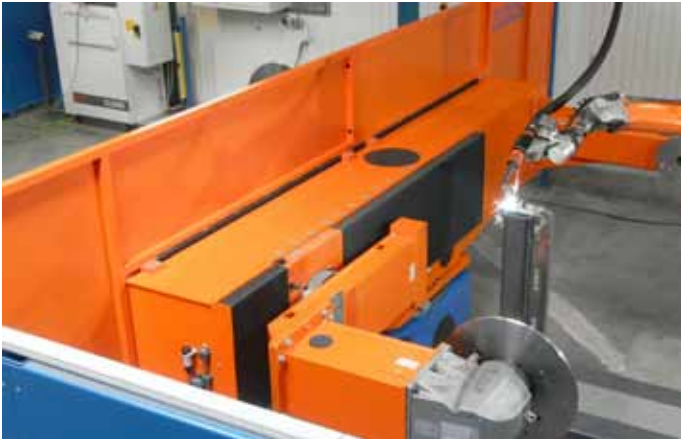
Bild 4: Der 2-Stationen-Aufbau beschleunigt den gesamten Fertigungsprozess deutlich.
