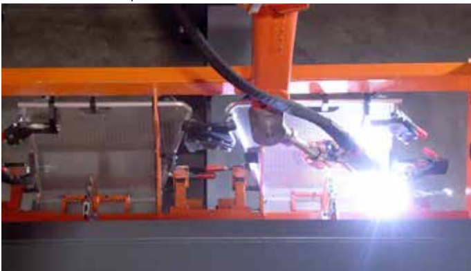
Bild 4: Der Schweißprozess MoTion Weld zeigt seine Stärken überall dort, wo besondere Anforderungen an die Nahtoberfläche und -optik gestellt werden.
