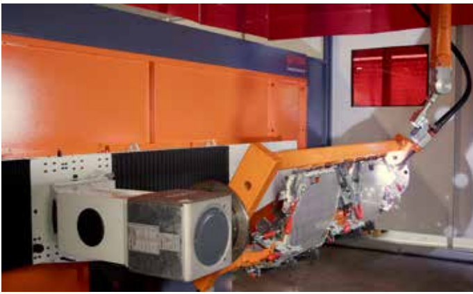
Bild 3: Unter anderem schweißt multi-cycles Seitengitter des Aluminium-Transportkorbs mit der Roboteranlage.
