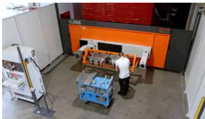
Bild 1: Durch den 2-Stationen-Aufbau kann die Anlage auf der einen Seite bestückt werden, während auf der anderen Seite der Roboter schweißt.
